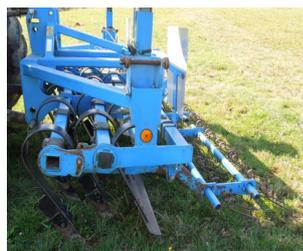
Pour des sols compactés en profondeur on peut utiliser des décompacteurs pour un travail en sous-solage 30 à 40 cm.
