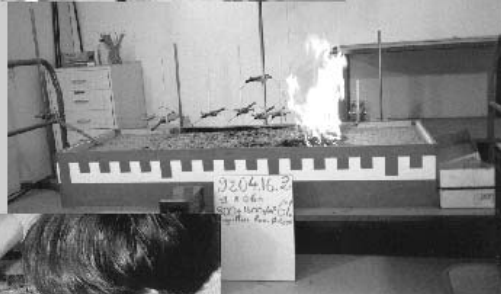
Les thermocouples sont fichés dans la motte, qui est enterrée dans du sable, puis recouverte de litière.
